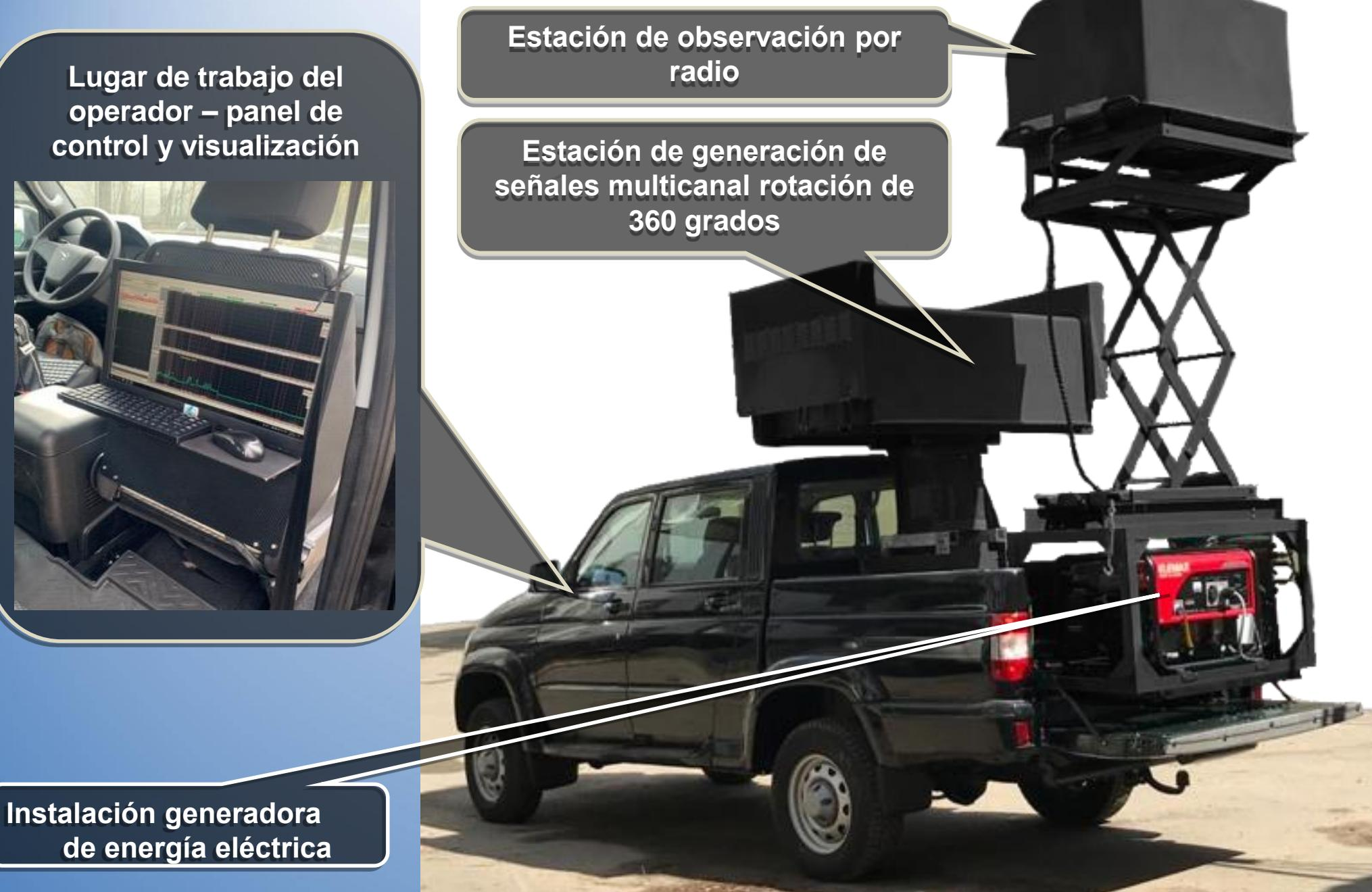
Instalación generadora de energía eléctrica
