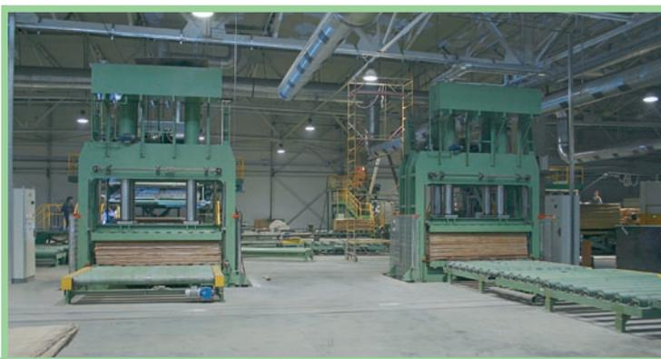
Прессы для холодной подпрессовки пакетов, придающие «распушённому» пакету фанеры компактность, обеспечивающую их беспрепятственную загрузку в горячий пресс.
